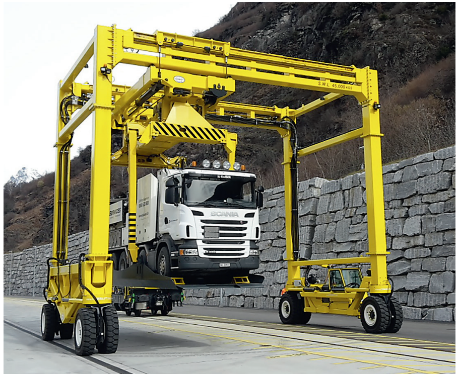
Comme une araignée, le Straddle Carrier tient fermement le camion d'arrosage dans ses griffes.
