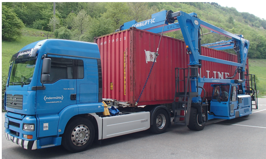
Le portique dans son élément, en train de décharger un camion.
